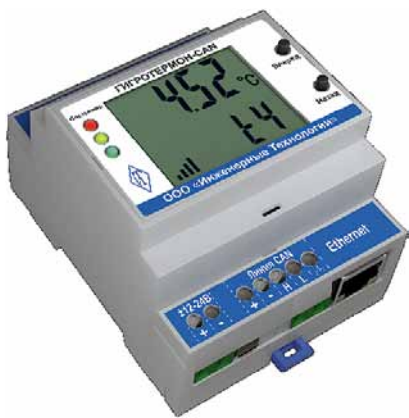
Рис. 1. Контроллер «Гигротермон-CAN»: внешний вид
