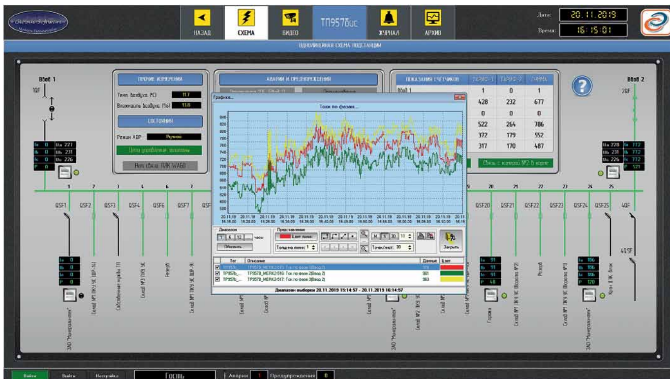
Рис. 4. Система удаленного мониторинга и диспетчеризации на базе SCADA TechnoSoft: распределительное устройство
