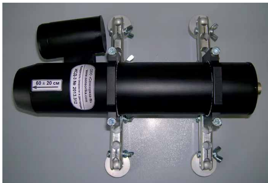
Рис. 3. Оптический датчик пути и скорости ИСД-3
