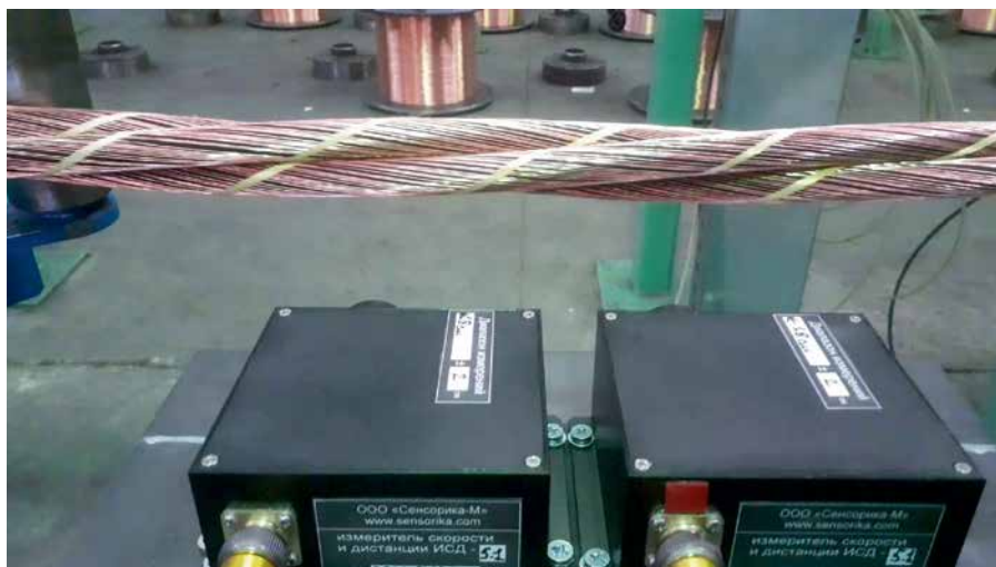
Рис. 2. Измерение длины витого кабеля с помощью датчика ИСД-5
