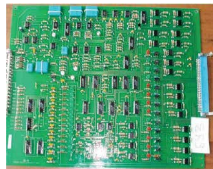
Рис. 4. Блок управления и защиты ГЛЦИ.758.727.239-01 плавного пуска высоковольтных электродвигателей
