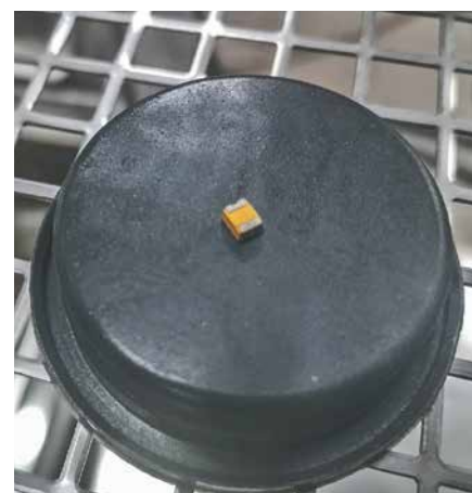
Рис. 3. В камере УСОТП-1 изделия можно располагать любым образом для отмывки парами азеотропного ТМС: a – общий вид; б – один из танталовых конденсаторов
