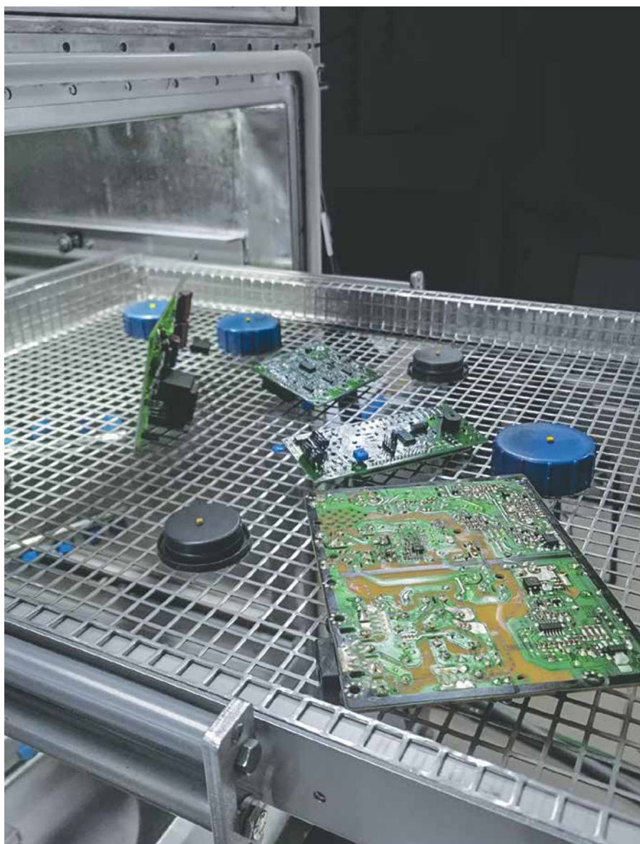
Рис. 3. В камере УСОТП-1 изделия можно располагать любым образом для отмывки парами азеотропного ТМС: a – общий вид; б – один из танталовых конденсаторов
