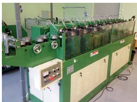
Рис. 7. Прокатный стан VT-16B
