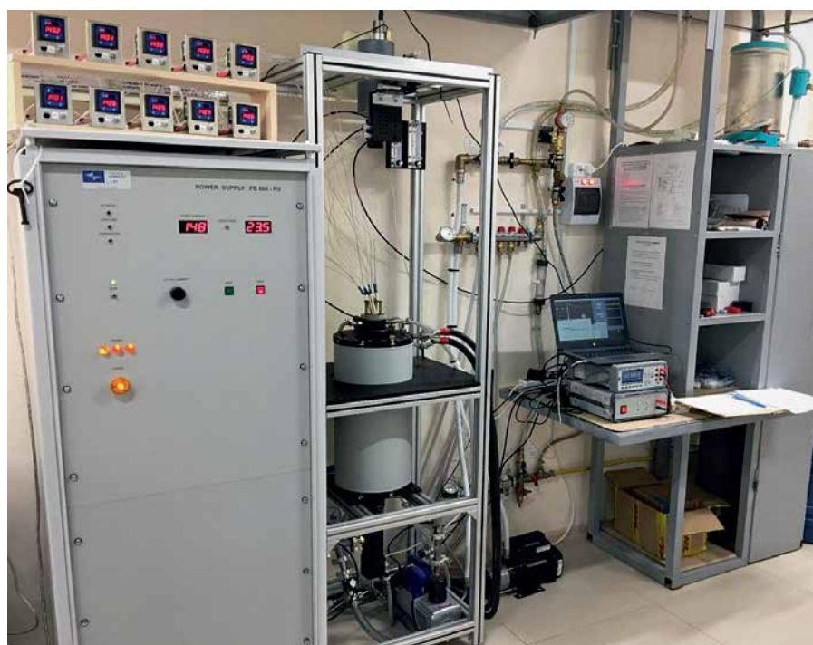
Рис. 2. Установка для калибровки высокотемпературных термопреобразователей
