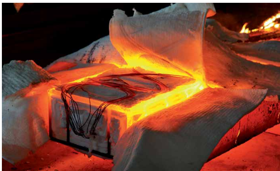
Рис. 3. Система мониторинга температуры заготовок с функцией телеметрии
