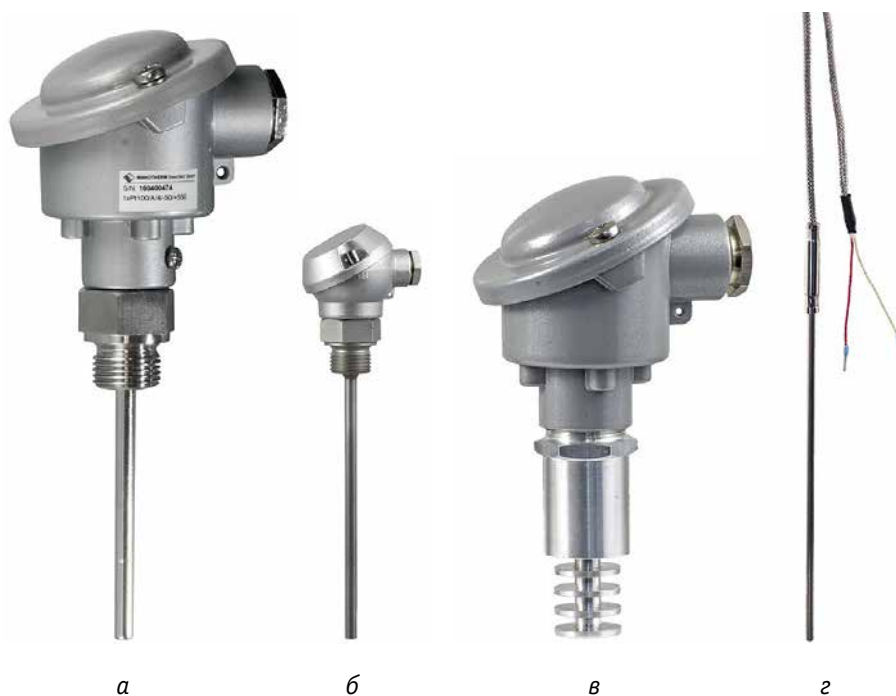
Рис. 1. Платиновые термометры сопротивления: а – для установки в защитную гильзу; б – в компактном исполнении; в – для измерения температуры окружающего воздуха; г – щуп с кабелем для присоединения к различным конструкциям
