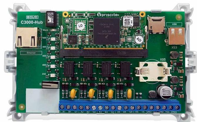
Рис. 2. Промышленный контроллер «М3000-УСПД»
