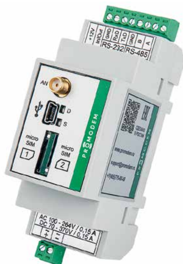
Рис. 1. Модем PROMODEM GSM-125.79M: RS-485 / RS-232, две сим-карты, встроенный БП на ~220 В, крепление на DIN-рейку, работа при -40...+70 °С
