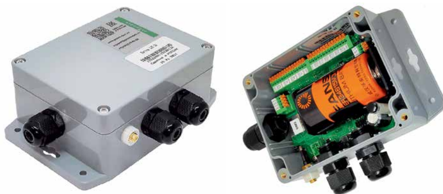
Рис. 5. Автономный промышленный модем PROMODEM GSM-125.09M с двумя портами RS-485 + RS-232 для подключения любых приборов учета, степенью защиты IP65 и батарей на несколько лет автономной работы; температура эксплуатации от -40 до +70 °С
