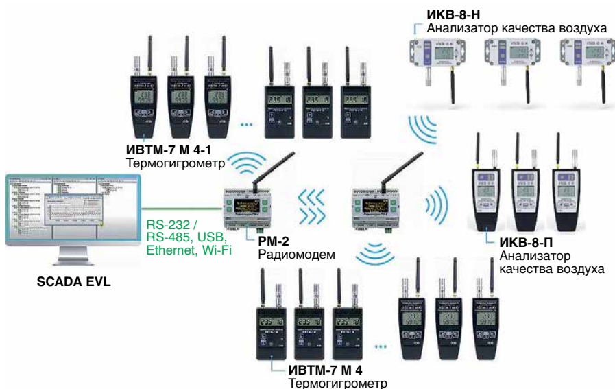
Рис. 2. Беспроводная система мониторинга на базе анализаторов качества воздуха ИКВ-8 и термогигрометра — ИВТМ-7 М 4
