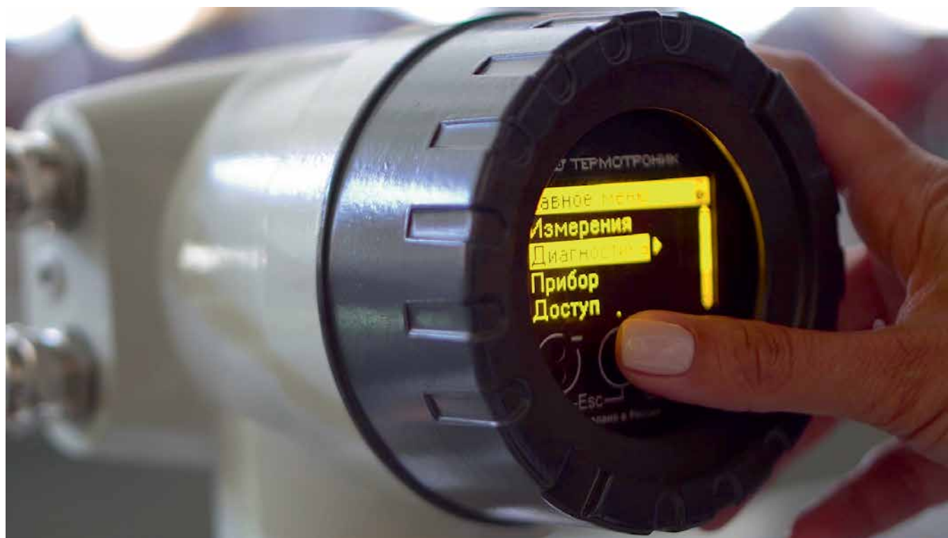
Рис. 3. Настройка промышленного расходомера ПИТЕРФЛОУ Т3
