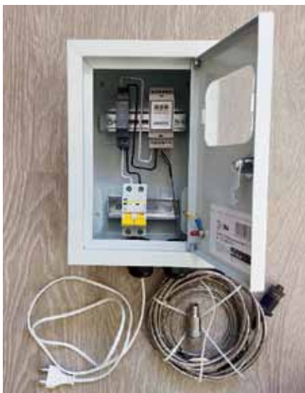
Рис. 1. Канал виброзащиты ВТС-1
