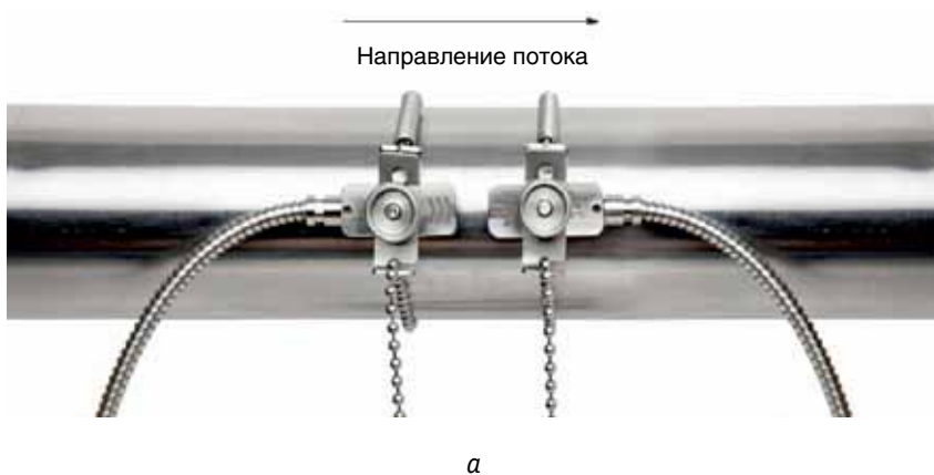
Рис. 2. Варианты установки накладных ПЭП на трубопровод: а – горизонтальная; б – вертикальная
