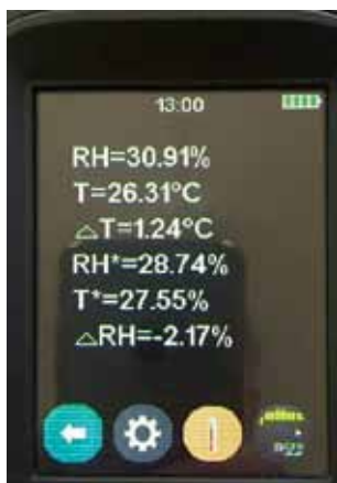
Рис. 9. Второй экран отображения измеряемых и вычисляемых параметров: \Delta T = 1,24 \text{ }^\circ\text{C}
