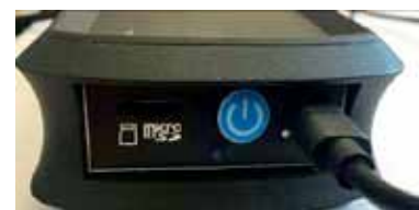
Рис. 12. Кнопка включения, кабель для связи с зарядным устройством (или с ПК)
