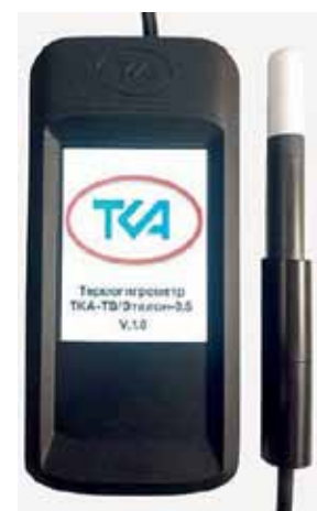
Рис. 3. Термогигрометр эталонный «ТКА-ТВ/Эталон»
