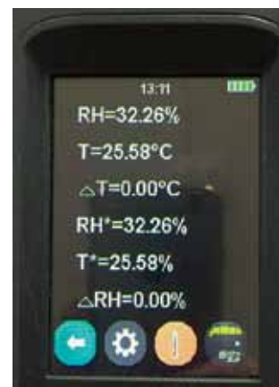
Рис. 8. Второй экран отображения измеряемых и вычисляемых параметров: \Delta T = 0
