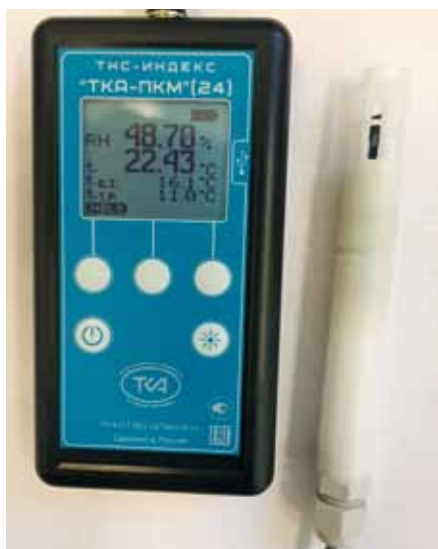
Рис. 2. Экспериментальный образец эталонного термогигрометра «ТКА»
