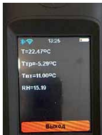
Рис. 11. Третий экран отображения измеряемых и вычисляемых параметров
