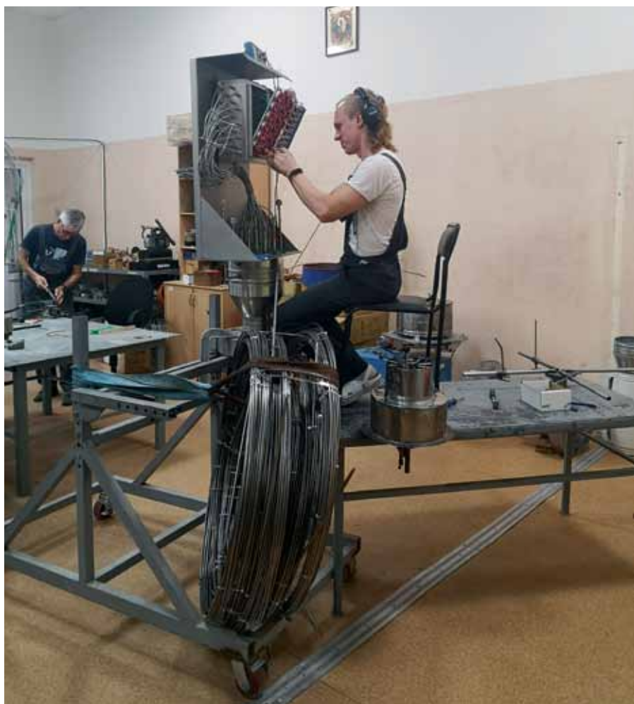
Рис. 4. Сборка термопар модели 03.17 на производстве
