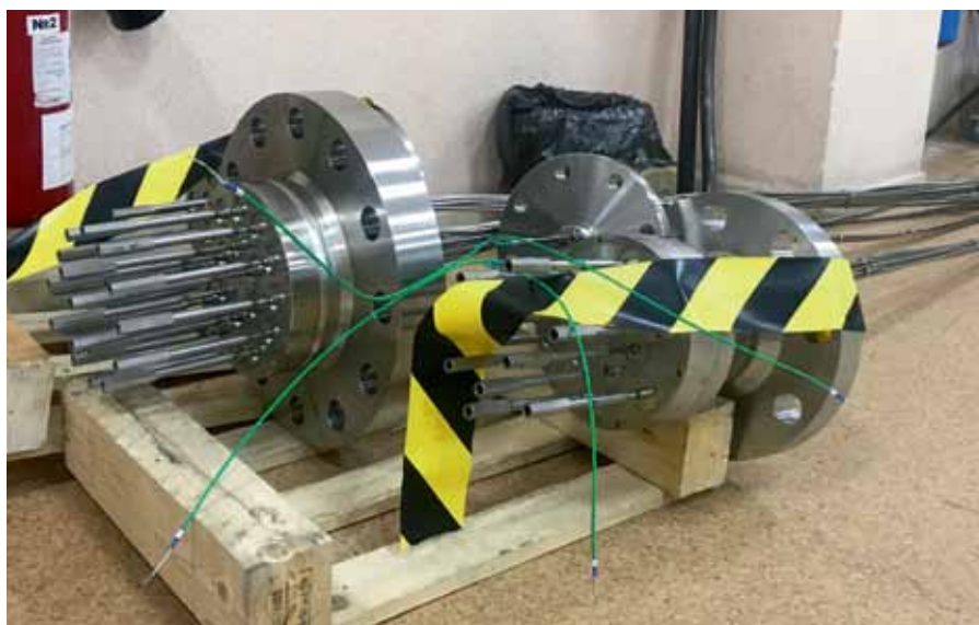
Рис. 2. Многозонные термопары КТХА Ех03.17 с камерой контроля утечек
