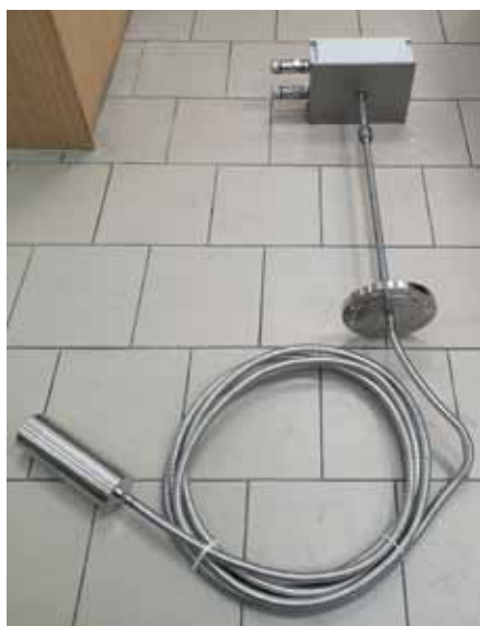
Рис. 1. Многозонный термометр сопротивления для резервуаров
