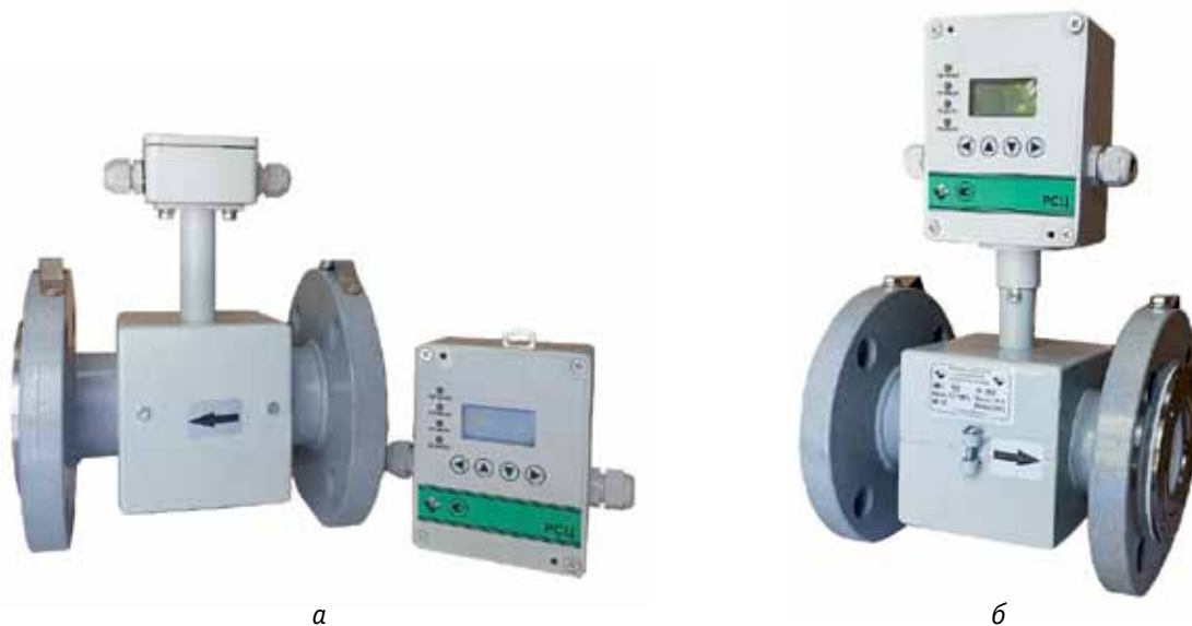
Рис. 1. Расходомеры-счетчики РСЦ: а – раздельное исполнение; б – общее исполнение
