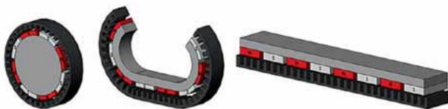
Рис. 2. Схематичное изображение кругового и линейного двигателей
