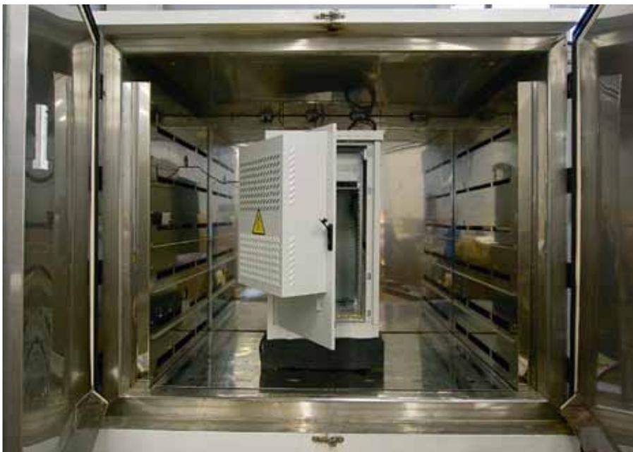
Рис. 1. Всепогодный шкаф ШТВ в термокамере на испытаниях
