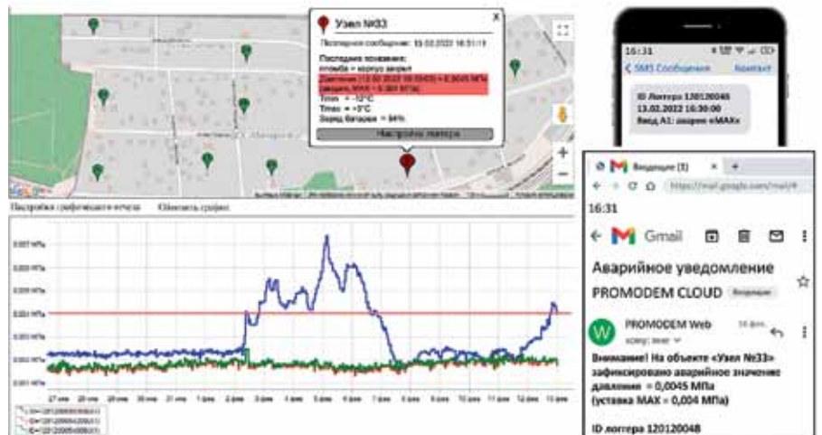
Рис. 5. Извещения об аварийных событиях: слева – индикация на веб-карте системы диспетчеризации PROMODEM CLOUD; справа – примеры аварийных e-mail и СМС-сообщений на телефоны сотрудников
