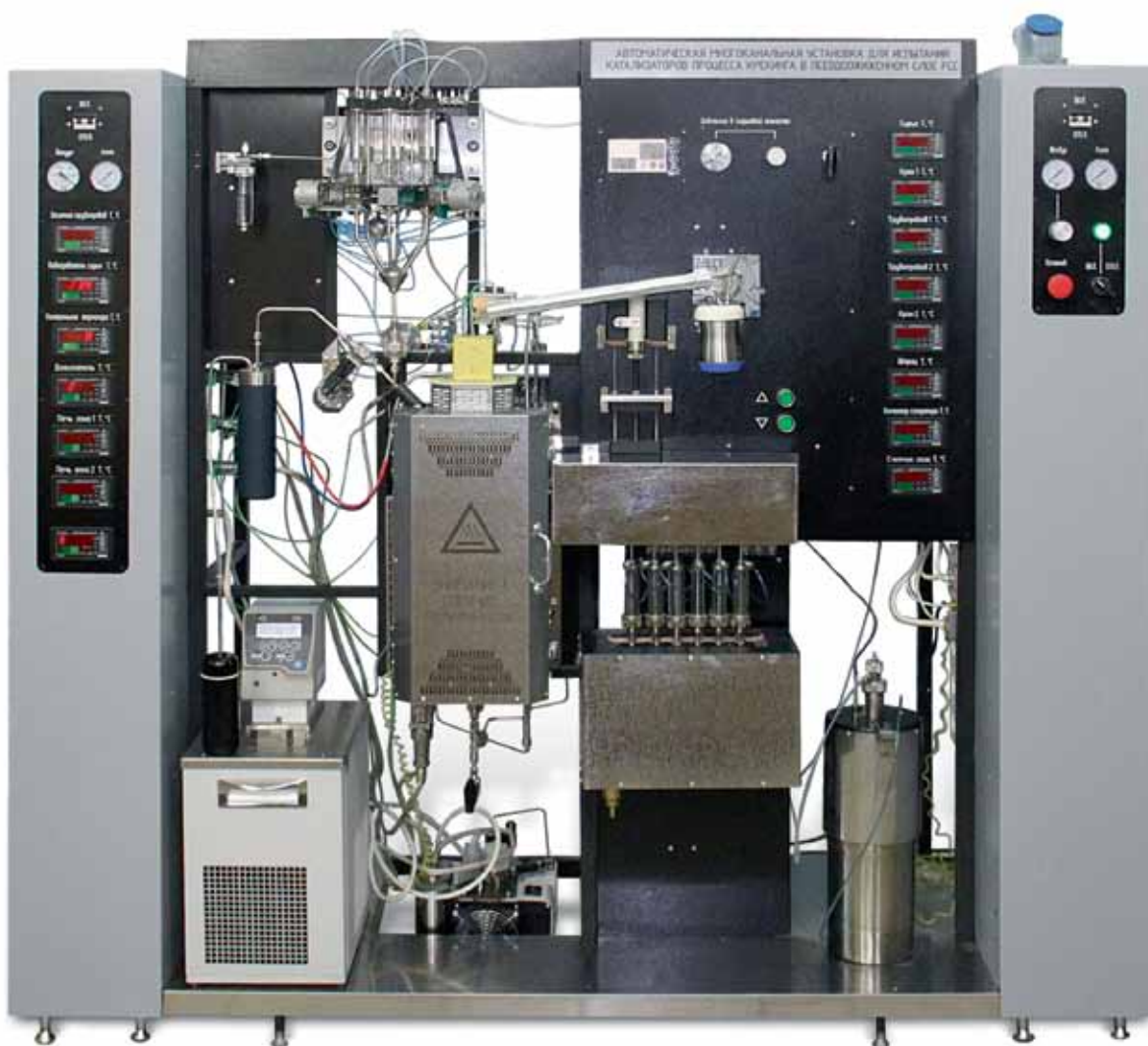
Рис. 4. Новая автоматическая многоканальная установка для испытаний катализаторов процесса крекинга в псевдооживленном слое FCC
