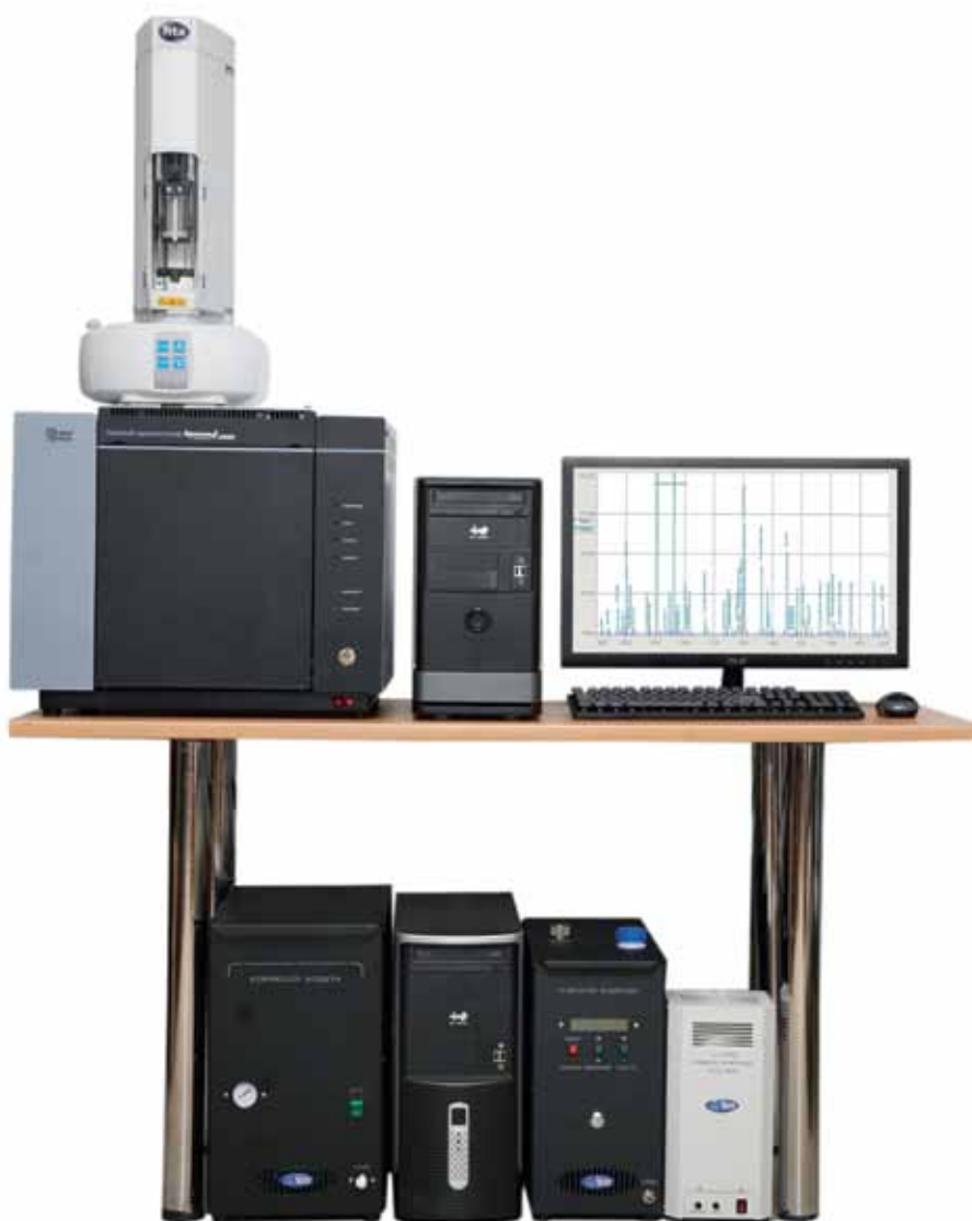
Рис. 1. Хроматограф «Кристаллюкс-4000М» с автосамплером, источниками азота, водорода, воздуха, компьютером
