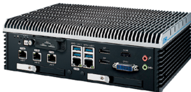
Рис. 3. Встраиваемый компьютер Vecow ECX-3025R
