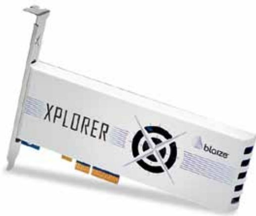
Рис. 2. ИИ-ускоритель Blaize Xplorer X1600P
