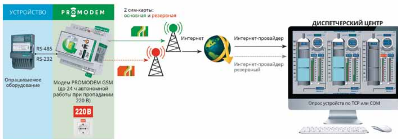
Рис. 4. Автоматический переход модема PROMODEM GSM-485-232-AC-UPS на резервный аккумулятор, резервного GSM-оператора или на IP-адрес резервного интернет-провайдера для гарантированного подключения к серверу
