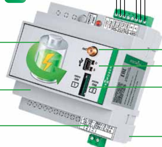
Рис. 3. Промышленный модем PROMODEM GSM-485-232-AC-UPS с двумя независимыми портами RS-485 + RS-232 для подключения оборудования разного типа и встроенным ИБП на несколько часов автономной работы; температура эксплуатации – от -40 до +60 °С, крепление на DIN-рейку
