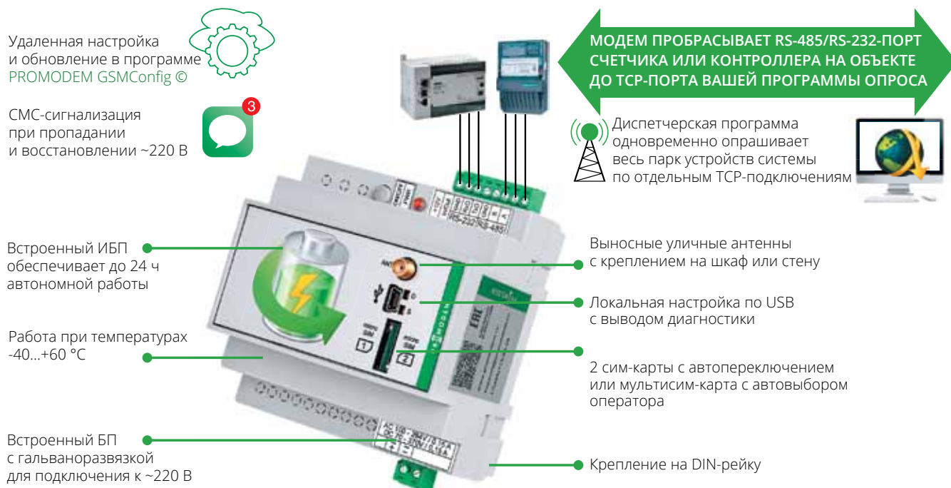
Рис. 3. Промышленный модем PROMODEM GSM-485-232-AC-UPS с двумя независимыми портами RS-485 + RS-232 для подключения оборудования разного типа и встроенным ИБП на несколько часов автономной работы; температура эксплуатации – от -40 до +60 °С, крепление на DIN-рейку
