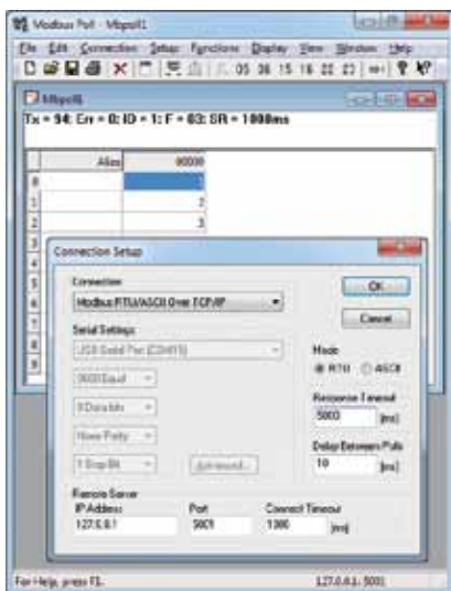
Рис. 2. Опрос удаленного Modbus-контроллера, подключенного к модему PROMODEM GSM, диспетчерской программой по TCP/IP через интернет
