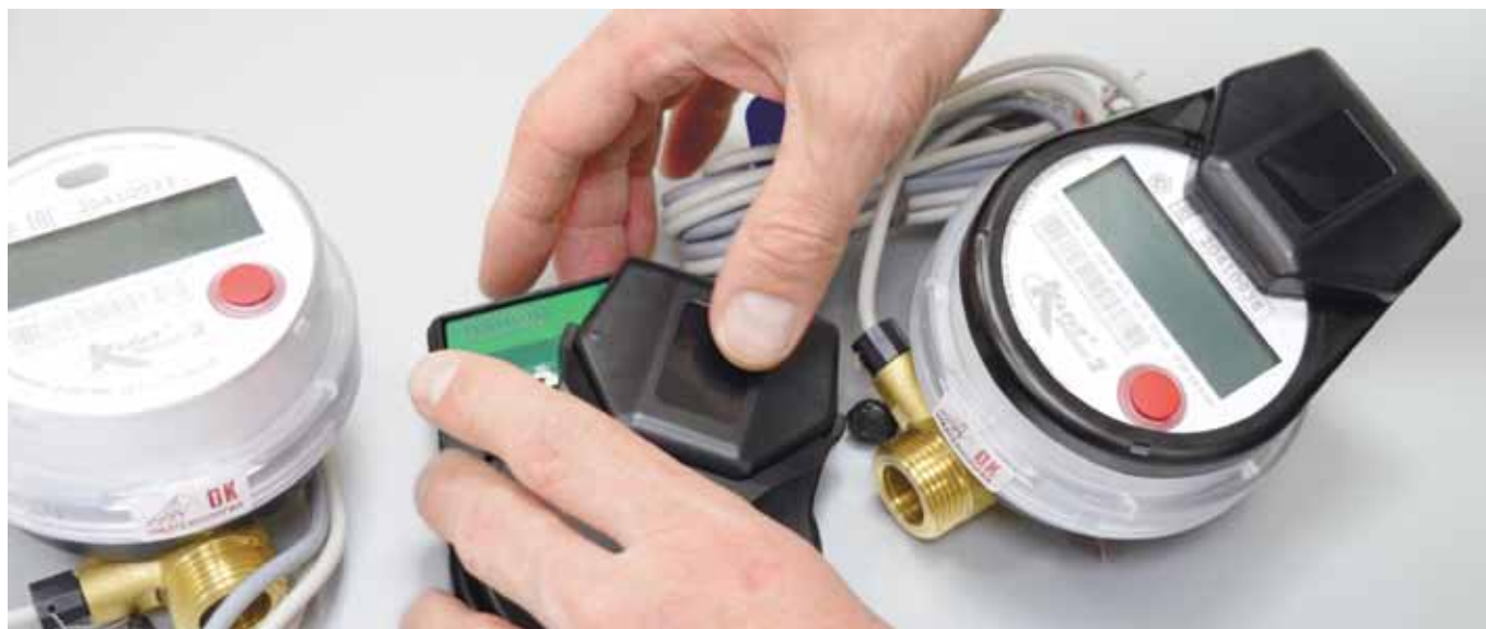
▲ Установка коммуникационного модуля КАРАТ-923 на квартирный теплосчетчик КАРАТ-Компакт 223
