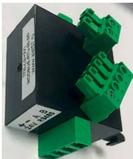
Рис. 3. Электронный трансформатор напряжения ТПОЗС с интерфейсом RS-485
