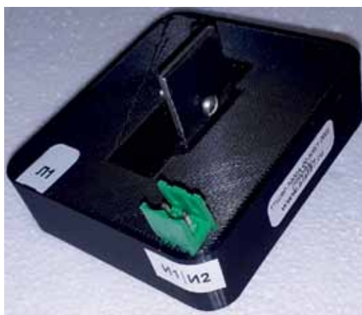
Рис. 6. Малогабаритные трансформаторы тока с выходом 5(1) А
