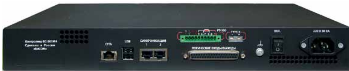
Рис. 4. Входы для подключения дополнительных датчиков
