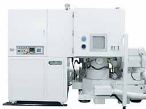
Рис. 2. Совмещенные климатическая камера и трехосевая вибрационная установка
