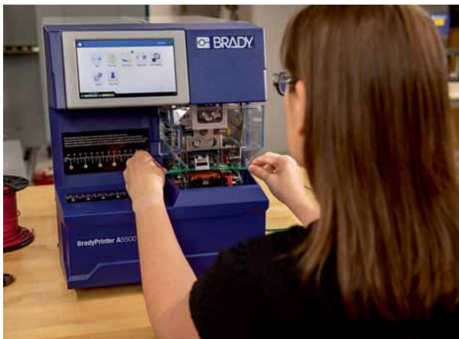
Рис. 4. Изготовление и нанесение флажковой этикетки с помощью принтера Brady A5500
