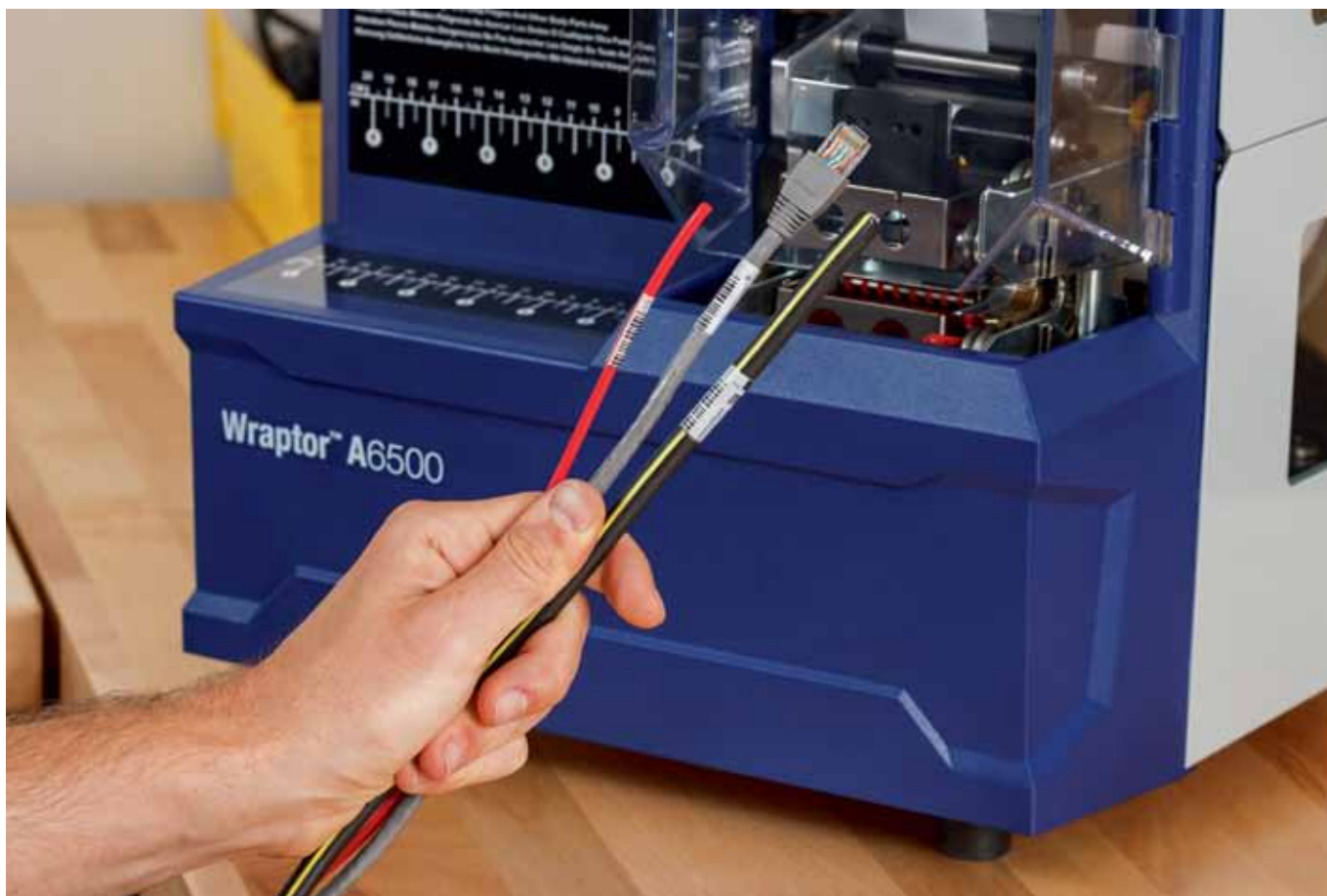
Рис. 2. Кабели и провода различных диаметров, маркированные на принтере Wraptor A6500
