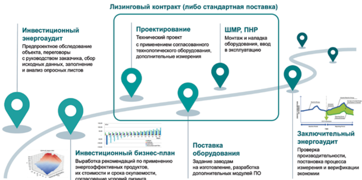
Рис. 9. Порядок реализации энергосберегающих мероприятий
