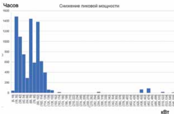
Рис. 7. Пример моделирования внедрения накопителя 1,8 МВт·ч на промышленном предприятии в целях снижения пиковой мощности
