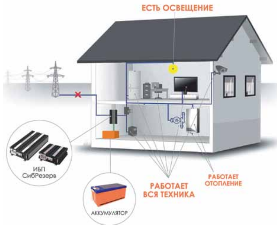
Рис. 2. Применение ИБП «СибРезерв 300 Offline», «СибРезерв 1000 Offline» и «СибРезерв 1000M Offline»
