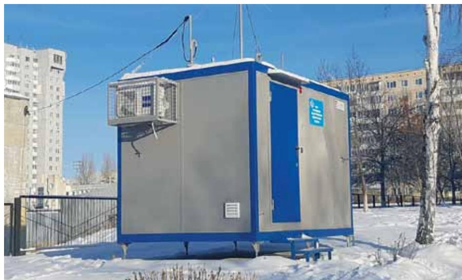
Рис. 1. Стационарный автоматический экологический пост «АЛМАЗ-01М»
