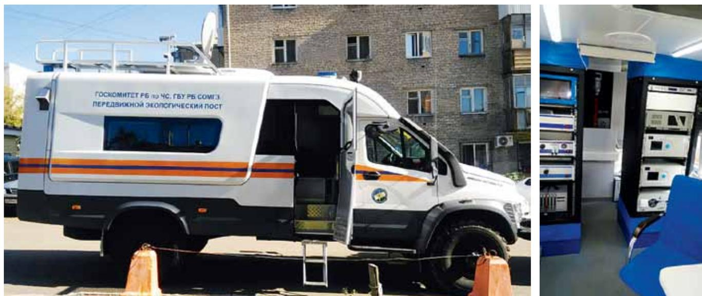
Рис. 2. Передвижная лаборатория экологического контроля и бортовое оборудование
