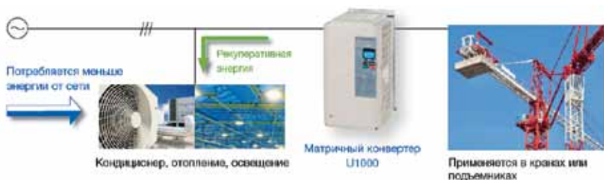
Рис. 2. Использование энергии в рекуперативном режиме с помощью МПЧ U1000
