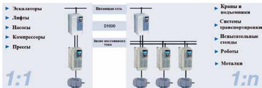
Рис. 4. Схема подключения рекуператора D1000
