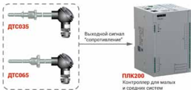
Рис. 1. Подключение датчиков с выходным сигналом «сопротивление» напрямую к контроллеру ОВЕН ПЛК200
