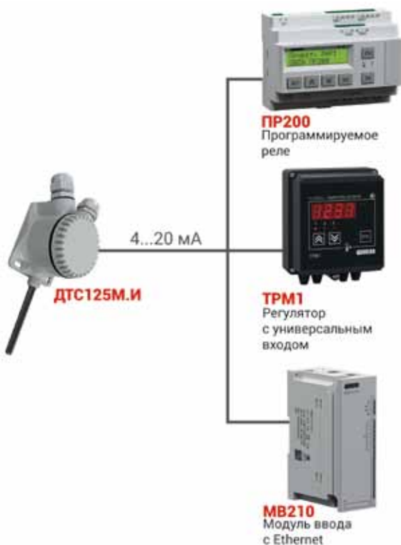
Рис. 4. Подключение датчика температуры наружного воздуха ОВЕН DTС125М.И с выходным сигналом 4...20 мА ко вторичным приборам
