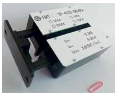
Рис. 2. Общий вид разъемных преобразователей измерительных тока до 1500 А
