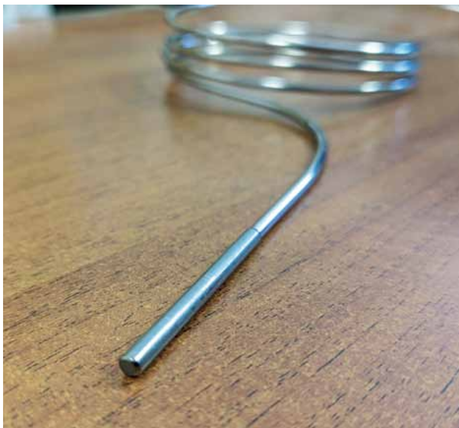
Рис. 2. Герметично заваренная гильза на конце чувствительного элемента
