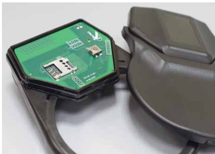
Рис. 1. Коммуникационный модуль КАРАТ-923 разработки и производства НПО КАРАТ
