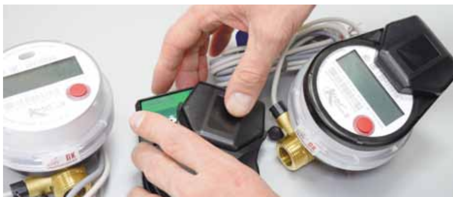
Рис. 2. Установка коммуникационного модуля KARAT-923 на квартирный теплосчетчик KARAT-Компакт 223
