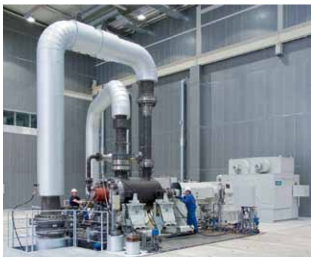
Рис. 4. Испытательный стенд для насосного оборудования
