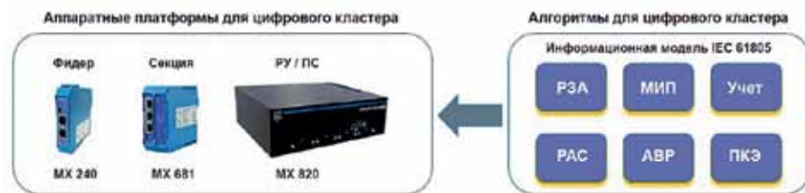
Рис. 2. Структурная схема цифрового кластера на базе TOPAZ iSAS®
