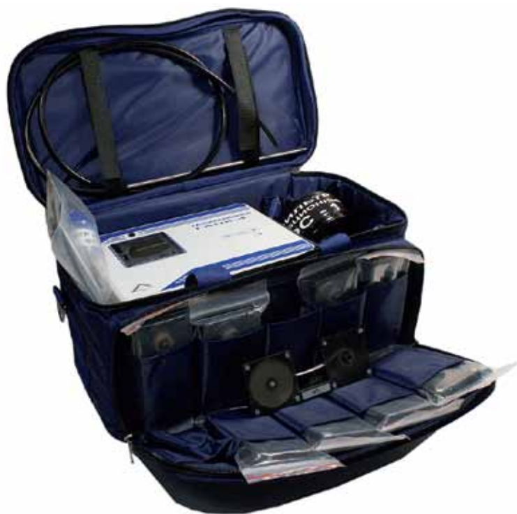
Рис. 1. Переносной газоанализатор ГАНК-4 А/Р/АР в сумке-термостате
