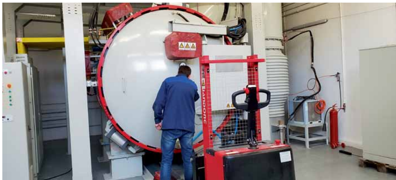
Рис. 2. Конструкционная пайка датчиков кориолисовых расходомеров в высокотемпературной вакуумной печи на заводе «ЭлМетро»
