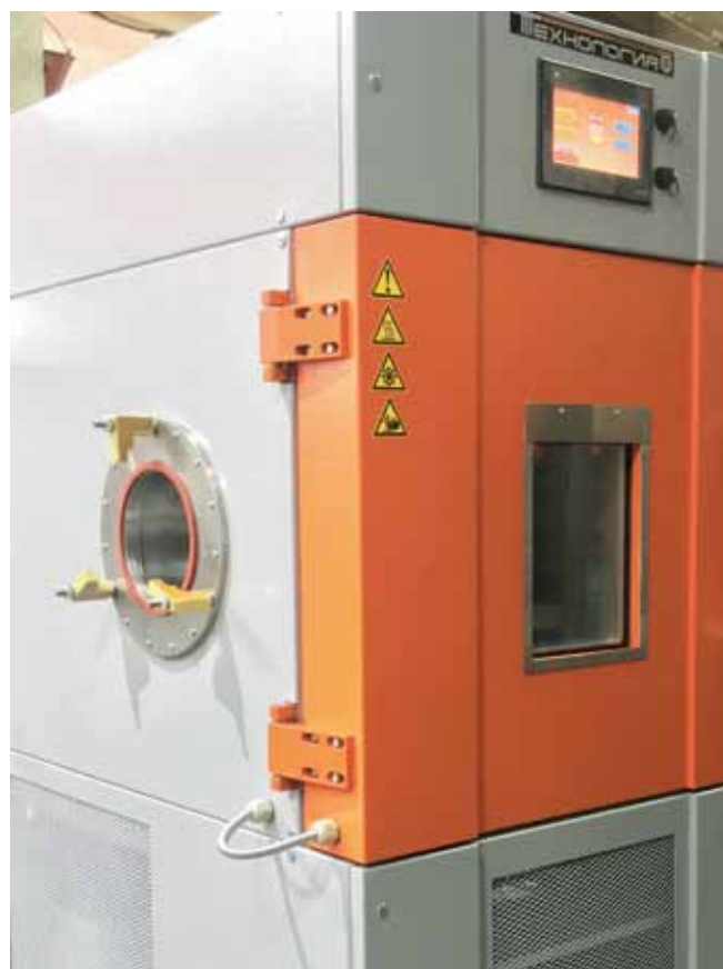
Рис. 3. Камера КТХВ-150 с нестандартным технологическим отверстием
