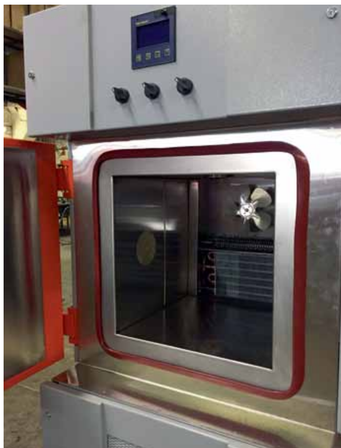
Рис. 2. Рабочий объем климатической камеры тепла-холода (КТХ)
