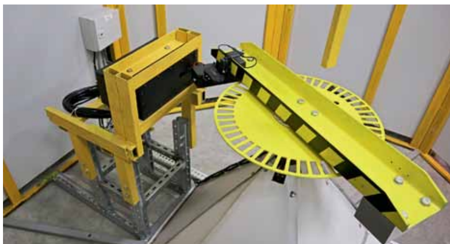
Рис. 6. Стенд испытаний ПРУ
