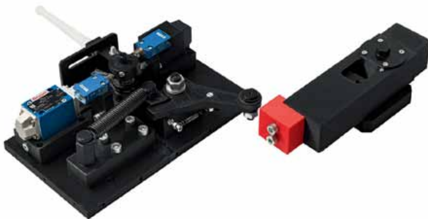
Рис. 5. Натурная модель ПРУ из пластика
