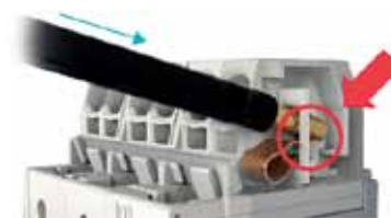
Рис. 6. Конструкция новых вставляемых (push-in) клемм, которые на глобальном рынке называются пружинными (spring clamp)
