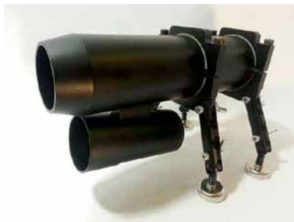
Рис. 2. Оптический датчик ИСД-3
