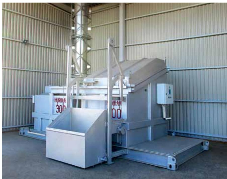
Рис. 1. Инсинератор «пассивного» сжигания
