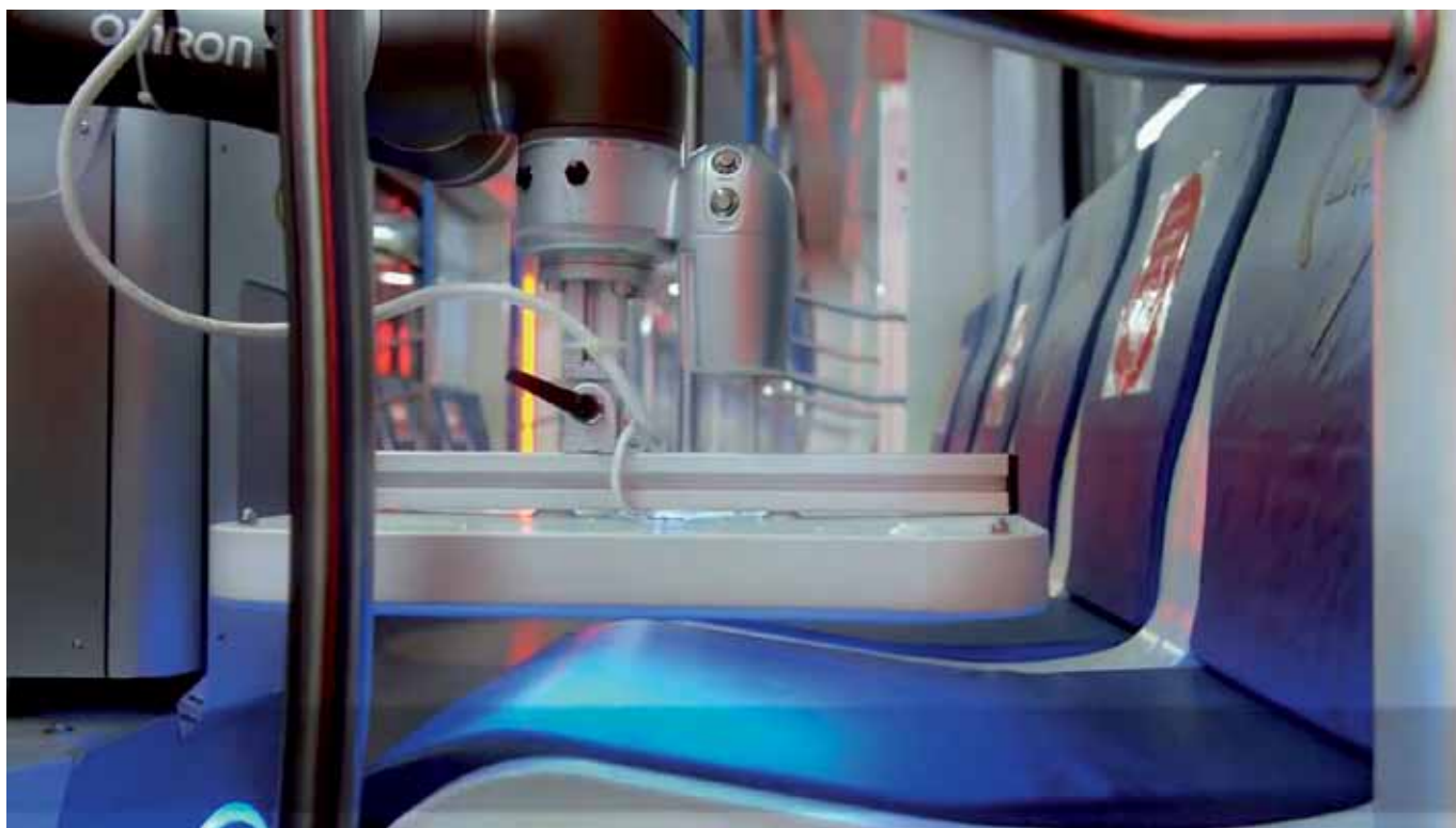
Рис. 3. Обработка сидений метро ультрафиолетом
