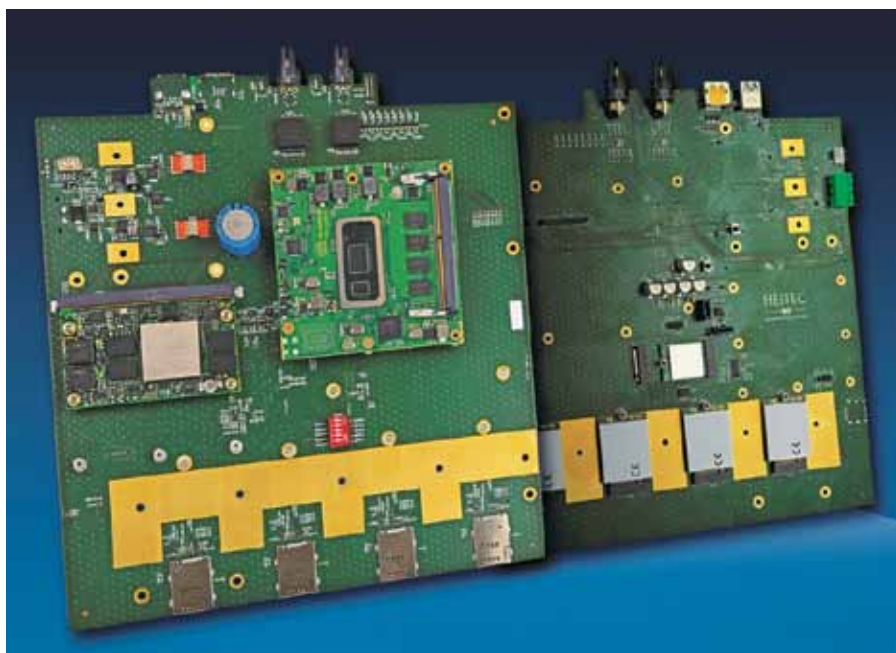
Рис. 4. Уникальная несущая плата HeiSys позволяет раскрыть преимущества применения архитектур COM Express и SMARC
