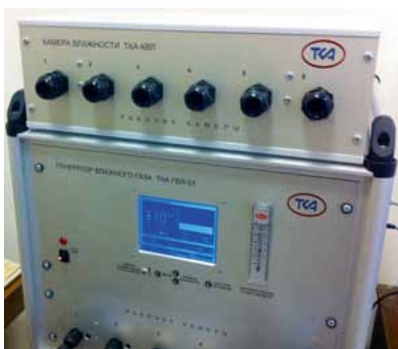
Рис. 4. Камера влажности «ТКА-КВЛ» с 6 рабочими портами
