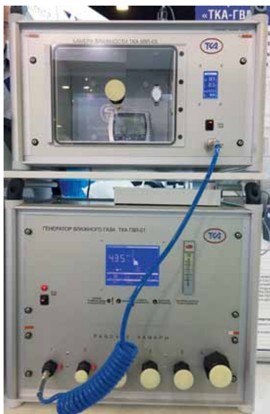
Рис. 6. Камера влажности «ТКА-КВЛ-03» подключена к генератору «ТКА-ГВЛ-01»
