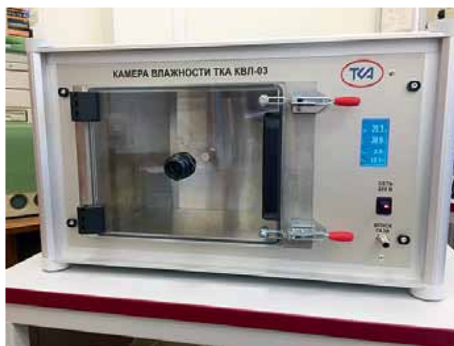
Рис. 5. Камера влажности «ТКА-КВЛ-03», рабочий объем 8,3 л
