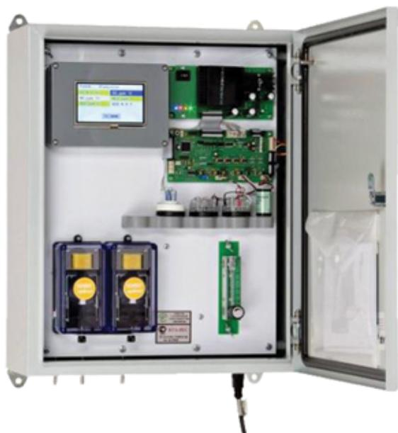
Измерение концентрации O<sub>2</sub>, CO, CO<sub>2</sub>, NO & NO<sub>2</sub>, CH<sub>4</sub>, SO<sub>2</sub>. Сочетание электрохимических и оптических методов. Двойной контроль кислорода - электрохимический и циркониевый сенсоры для технологического применения. Полный комплект сенсоров для ГТУ. Контроль метана в остановленном котле, перед розжигом и в процессе работы. Передача данных по GSM и мгновенная связь с фирмой-производителем.
