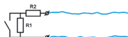
Рис. 2. Контакт с контролем целостности цепи
