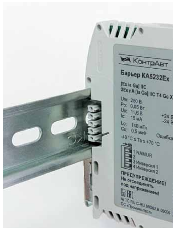
Рис. 5. Барьер имеет шинный соединитель
