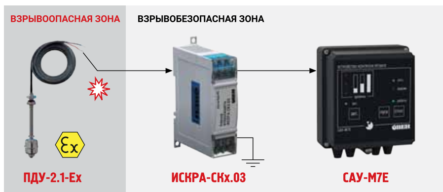
Рис. 3. Подключение сигнализаторов ПДУ-Ех через барьер искрозащиты ИСКРА-СК
